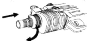
A2 для того чтобы снять дуло, поверните его на пол-оборота против часовой стрелки
