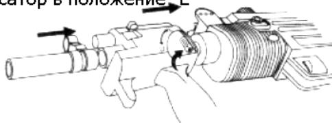
B2 установите фиксатор в положение "U" и снимите длинное дуло
