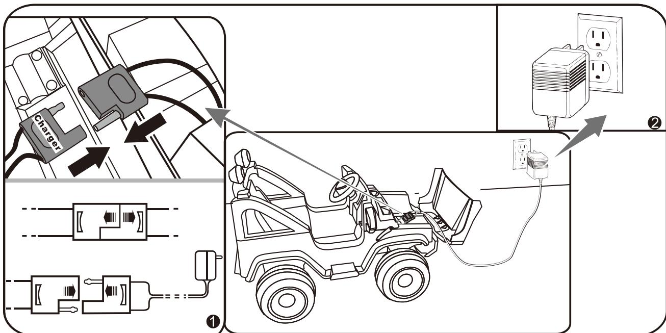
1. Отсоедините аккумулятор, как показано на рисунке. Вставьте разъём зарядного устройства в соответствующий разъём аккумулятора.
