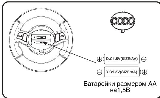
Используя отвертку, снимите крышку в центре руля и вставьте две батарейки размера АА.
