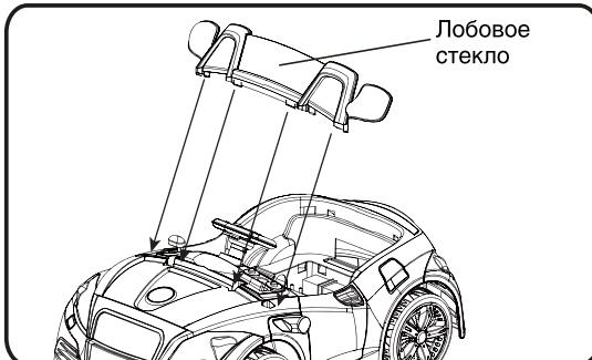
Установите стекло на корпус автомобиля так, чтобы совпали выемки на стекле с отверстиями на корпусе. Надавите до щелчка, означающего, что стекло зафиксировано.
