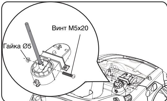
Вденьте винт M5x20 через деталь Д/У и рулевой вал и закрутите все это гайкой Ø5
