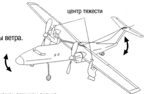
Если центр тяжести смещен слишком сильно, подвиньте аккумулятор и закрепите его
