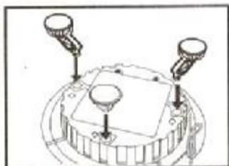
1. Закрепите ножки на пусковой платформе.
