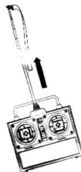
3) Установите выключатель питания самолета в положение "ON"
