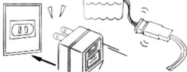
3) По окончании зарядки отсоедините зарядное устройство от сети и выньте штекер аккумулятора из патрона зарядного устройства.
