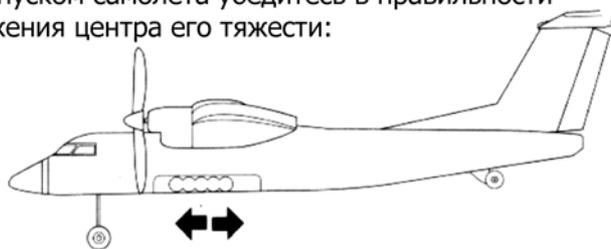
Правильно установите крыло и аккумулятор. Приподнимите самолет кончиками пальцев под крылом в районе меток. Самолет должен остаться в горизонтальном положении.
