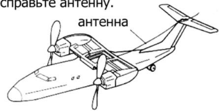
4. Вставьте антенну в паз полочки горизонтального хвоста и закрепите ее.
