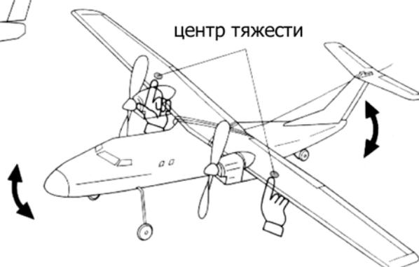
Убедитесь в правильности установки крыла и хвостовой части самолета. Вертикальный хвост должен быть перпендикулярен крылу, а крыло должно быть параллельно уровню земли. Изменение углов может привести к затруднению полета и даже к поломке самолета.
