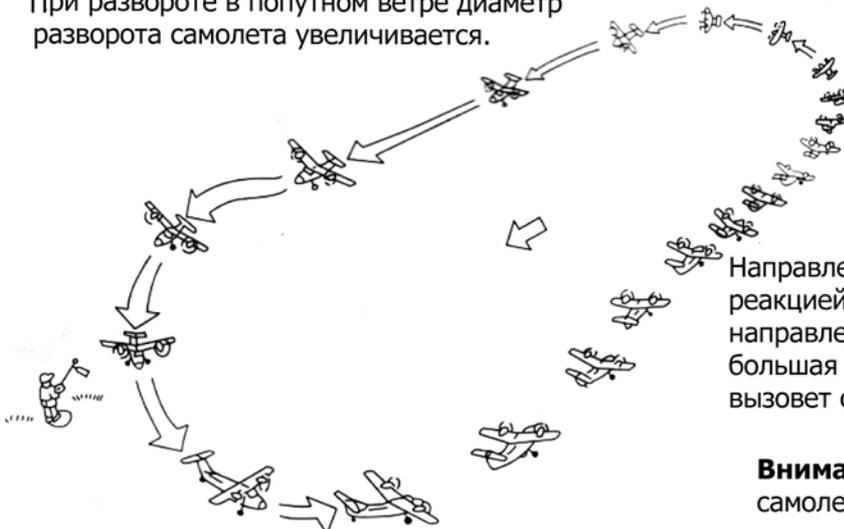
Направление ветра: внимательно следите за реакцией самолета и вовремя регулируйте направление и скорость полета. Слишком большая высота полета при попутном ветре вызовет снижение скорости.
